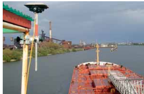
„Squat“-Messungen vor Ort auf der Weser und in Simulation: Ein fahrendes Schiff liegt tiefer im Wasser als im Ruhezustand; dieser Einsink-Effekt wird als Squat bezeichnet. Die „Weser Stahl“ im Bild unten wurde auf ihrem Weg nach Bremen daraufhin gemessen. Im Vordergrund ist ein Teil der Messeinrichtung zu erkennen, die GPS-Antenne. Der rote Punkt neben den Dalben ist das Begleitboot der Wissenschaftler. Das obere Bild zeigt ein 3D-Modell zur Bestimmung des Wasservolumens um das Schiff – eine wichtige Einflussgröße für den Squat.
